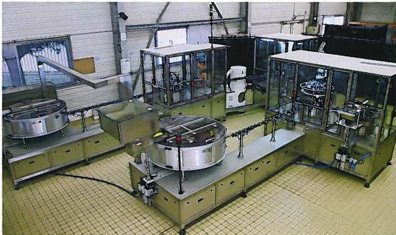
Die Anlage schweißst sogenannte Dripper für Bewässerungsanlagen. Foto: Herrmann Ultraschall
