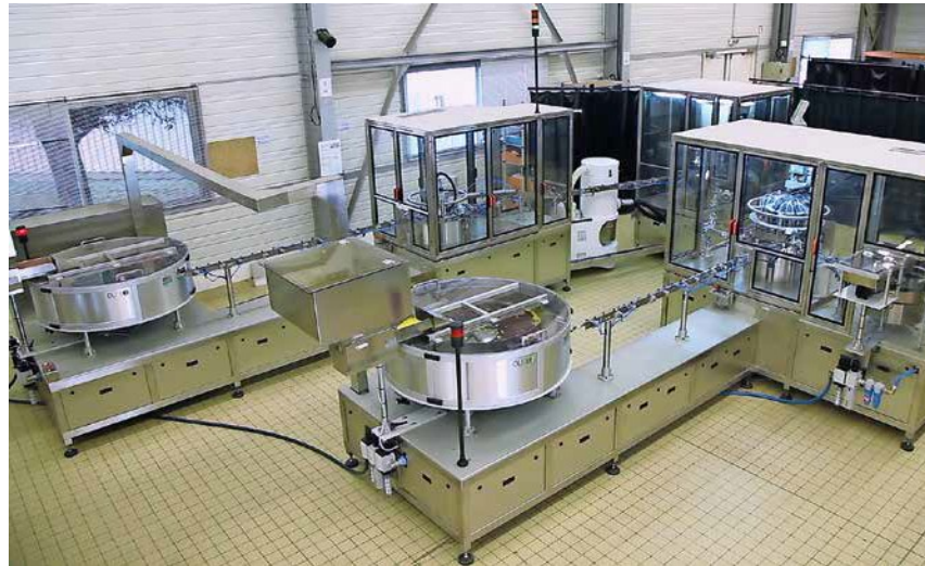
Die Maschine kann pro Sekunde bis zu zehn Schweißvorgänge ausführen.
