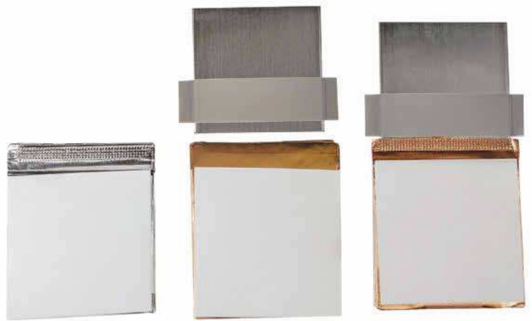
So funktioniert das „Pre- und Tab-Welding“ bei der Lithium-Ionen-Batterie: Sowohl die Anode (Kupfer) als auch die Kathode (Aluminium) werden 2-stufig gefertigt – beide sind im Bild von oben zu sehen. Im ersten Schritt werden über 50 Folien per Ultraschall verschweißt (links), dann wird dieser „Pack“ mit dem Ableiter ultrashallverschweißt (Mitte und links).
