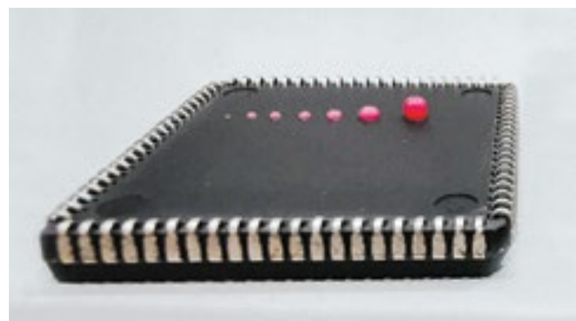
Delo Monopox EG2596: Der Kleber lässt sich präzise in Tröpfchenrößen von 450 bis 2.400 µm auftragen - durch mehrmaliges Dosieren auf denselben Punkt. Foto: Delo
