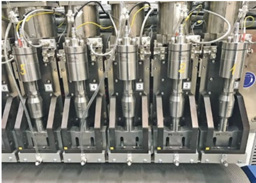
Die aus elektrischen Signalen erzeugten mechanischen Schwingungen werden durch einen Booster und die Sonotroden in die zu verbindende Bahn eingeleitet. Foto: Weber Ultrasonics
