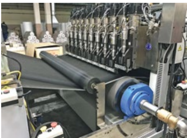
In der Ultraschallschweißanlage werden zwei Lagen Nonwovens und eine dampfdurchlässige Folie in einem kontinuierlichen Laminierprozess zu Dachunterspannbahnen miteinander verbunden.
