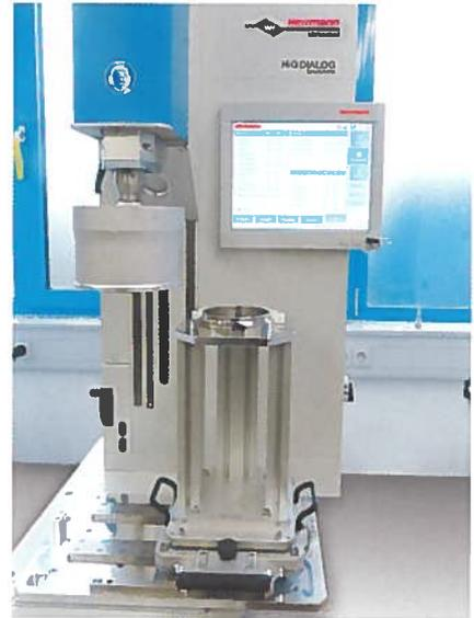
**Bild 4.** HiQ Dialog 6200: Die Ultraschallschweißmaschine besitzt eine höhenverstellbare Werkstückaufnahme und kann mit ihrem 15-Zoll-Display den Verlauf der Schweißung grafisch darstellen © Herrmann Ultraschall
