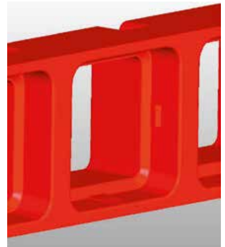
Bild 6. Zentriernoppen im Kammerinnern stellen die Positionierung der Bauteile zueinander innerhalb der geforderten Toleranz sicher (© Herrmann Ultraschall)
