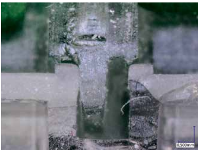
Bild 5. Das Schnittbild am Anfang der Versuche zeigt, dass das Bauteil noch nicht korrekt vermittelt ist und eine weitere Änderung des Spritzgießwerkzeugs erfolgen muss (© Herrmann Ultraschall)
