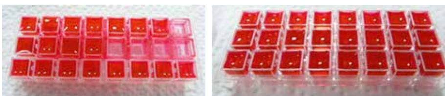
Bild 3. Dichtheitsprüfung mittels des Farbstoffes Rhodamin: links ein undichtes Bauteil während der Versuchsschleifen, rechts ein dichtes Bauteil am Ende der Anwendungsentwicklung
