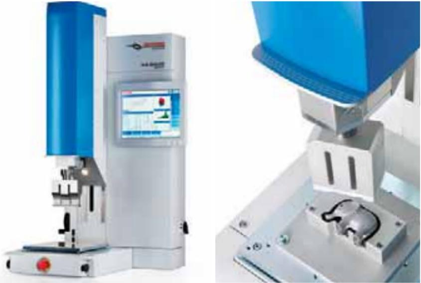
Herrmann Ultraschall entwickelt und fertigt Maschinen, Komponenten und Systeme zum Ultraschallschweißen von thermoplastischen Kunststoffen, Packstoffen und Vliesstoffen. Unsere Kunden sind namhafte Hersteller wie Bosch, Gardena, Playmobil, Continental und Nestlé.
